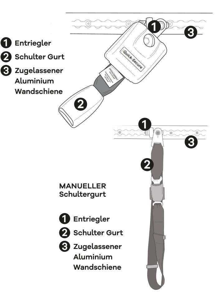
So befestigen Sie Ihren Quicksecure Boden Retraktor, WHEELCHAIR & OCCUPANT RESTRAINT SYSTEM VORNE
